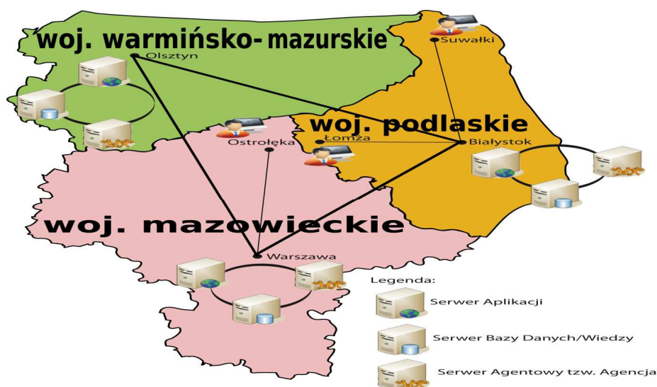
Ryc. 4 Przykładowa realizacja architektury agentowej dla warstwy programowej składającej się z trzech węzłów głównych [Opracowanie własne]
